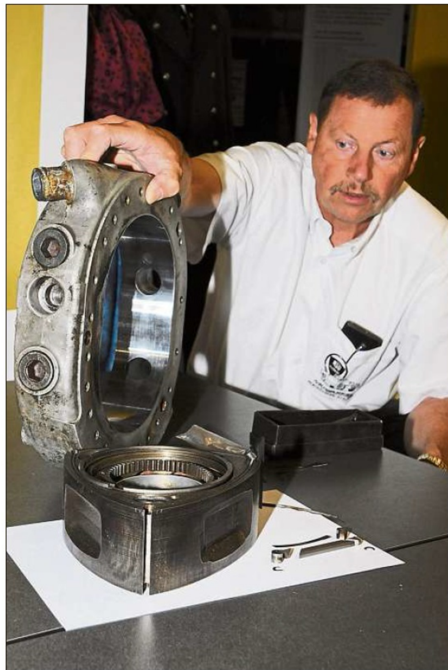
Uli Latus hält den Rahmen, in dem sich der Kolben beim Wankelmotor dreht.
