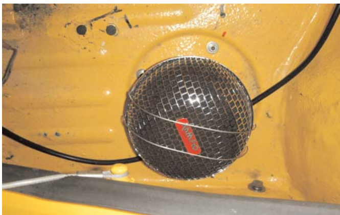
Der neue Sportluftfilter des SU-Vergasers
