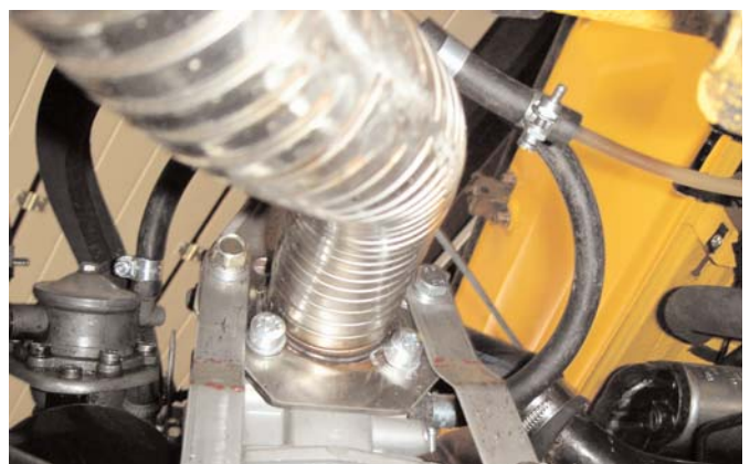
Flansch zwischen Vergaser und Ansaugrohr
