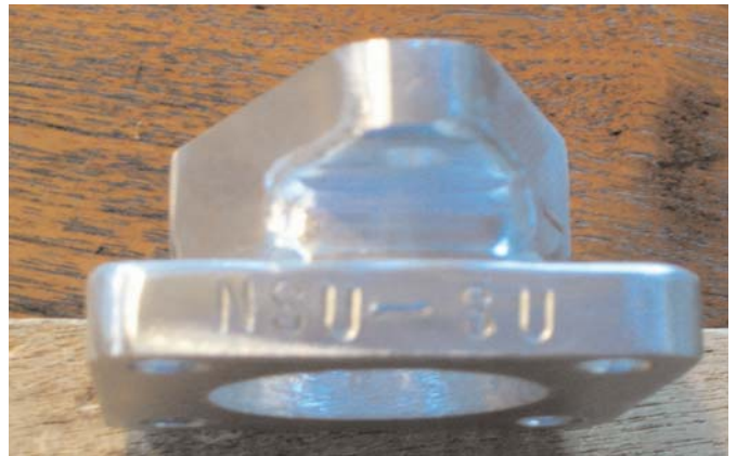
Das Übergangsstück in der Draufsicht
