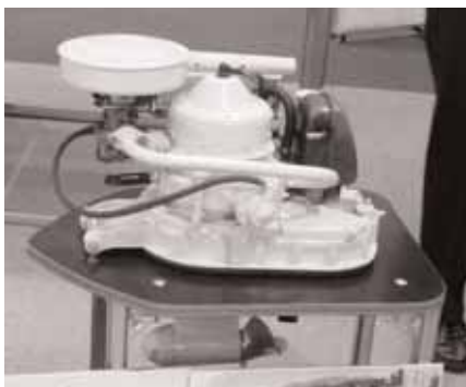
Wankelmotor vom Wasserskigerät
