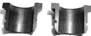
Zweiteilige nachgefertigte Buchse
