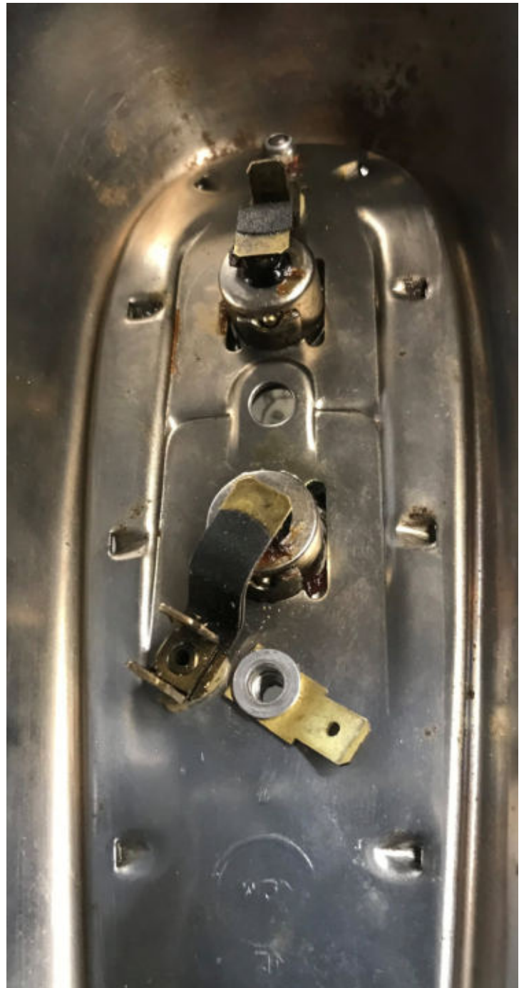
Die untere Messingniete muss durch einen Gewindeniet ersetzt werden.
